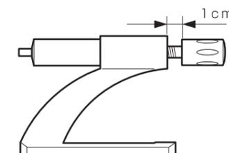
④ ブラケット本体と中間サポートを付属の取付けネジ(ナベφ3.5×35)で取付けてください。
