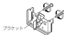
※ ブラケットの取付け高さにバラつきがあると、レールが取付けられません。必ず各ブラケット高さを合わせ、固定してください。
