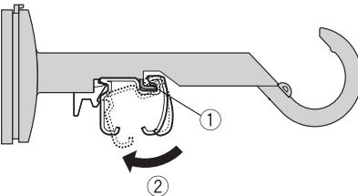
① リングランナー、エンドリングランナー、キャップをセットしたポールをネクスティダブルブラケットにのせて、左右のポールの長さを確認してください。
