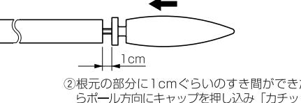
\* キャップがポールに引っ掛かって抜けにくい場合はキャップアウター(透明の樹脂の部分)と一緒に掴んで抜き取ってください。
