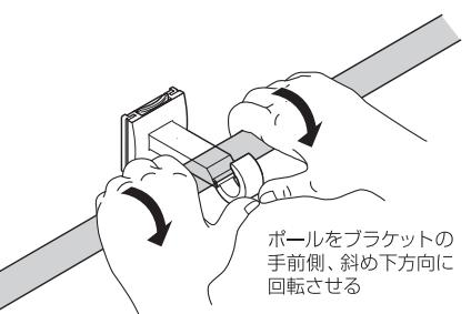
② ネクスティダブルブラケットの先端に親指を当てながらポールをブラケットの手前側、斜め下方向に回転させて取付けてください。ポールストッパー(透明の樹脂の部分)を乗り越えてポールが固定されます。
