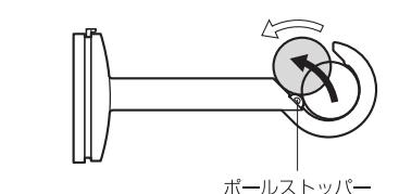
● ネクスティレールは、レールの後の白い突起(①)を後に押しながら(②)、手前斜め上方向に回転させ(③)、取外してください。
