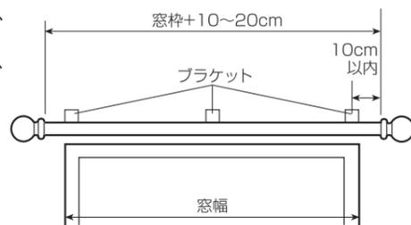
② レールにランナー、マグネットランナーを必要数セットし、左右のキャップストップを取付けてください。
