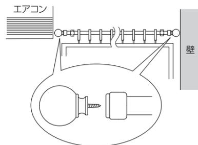
④ エリートシングルブラケットをダブル付けエンドブラケットに取付けてください。
