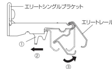
③ 取付けネジを外してブラケットを、取外してください。
