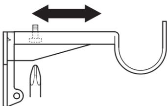
② 左右のダブル付けエンドブラケットを取付けネジで取付け、ポールを乗せてください。
