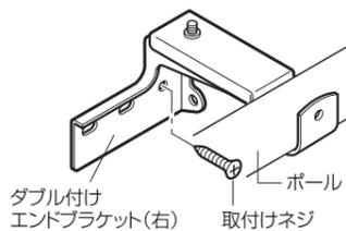
③ キャップ固定ネジが、正面から見て見えない位置にポールを回してから飾りネジを手で回して固定してください。
