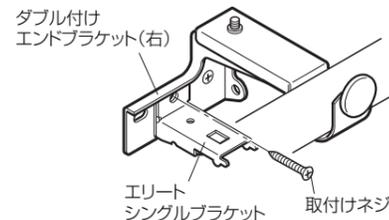
⑤ 残りのエリートシングルブラケットを壁面などに等間隔に取付け、エリートレールをセットしてください。
