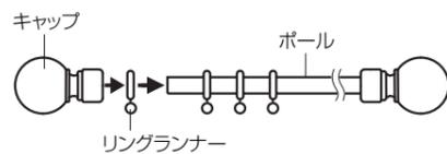
※キャップ固定ネジはポール表面フィルムの貼り合わせラインに合わせて締めつけるようにしてください。
