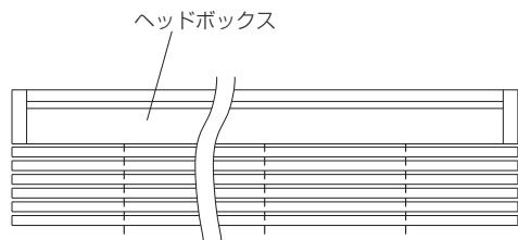
②ヘッドボックス内のシャフトとブーリーボックスとの接合部分にあるネジをゆるめ(①)、シャフトをブーリーボックスより外してください。ヘッドボックス下側穴より樹脂部分を押し上げながら(②)、ブーリーボックスをスライドさせヘッドボックスより抜き取ってください(③)。
