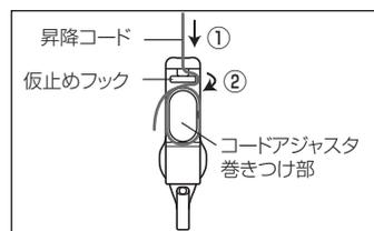
※ コードアジャスタの上部から昇降コードを通し(①)、固定位置をコードアジャスタ上部に合わせてください。コードは、仮止めフックに引っ掛けて反対側の方向に振ると(②)仮止めができます。余った昇降コードをコードアジャスタに巻きつけてください。
