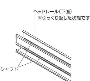
②ジョイントプレートの固定ネジ4ヶ所と、非操作側のシャフト固定リングの固定ネジ2ヶ所、側面固定ネジ1ヶ所をゆるめてください。
