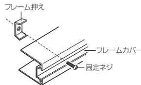
※固定ネジの仮止めは、図のようにフレームカバーとフレーム押えが当たる程度にしてください。
