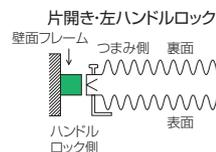
片側固定フレーム、片側壁面フレームを使用し、壁面フレーム側にハンドルロックが付きま。
