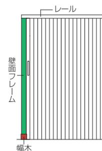
※壁面フレームはクローザ エクセルの製品高さでご注文ください。(10mm単位)
