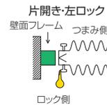
片側固定フレーム、片側壁面フレームを使用し、壁面フレーム側にロックが付きま。
