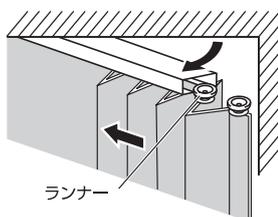
③レールをもとの位置に戻し、付属の取付けネジ(サラφ3.0×16)で固定してください。
