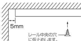
②レールの溝を下にして、レールの端から本体上部に付いているランナーを差し込みます。
