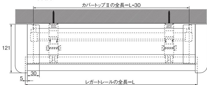
カバートップIIをジョイントして使用する場合のカット寸法=(L÷2)-20mm
