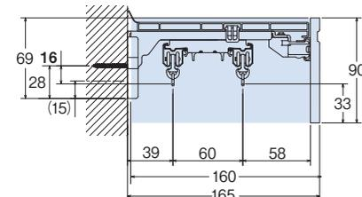
※ ( ) の寸法は窓枠上の横下地に取付ける際の取付ネジの寸法です。
