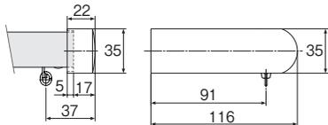
※メタルキャップストップM(ダブル)を使用する場合、エリートレールはレガートレールより30mm短くカットしてください。
