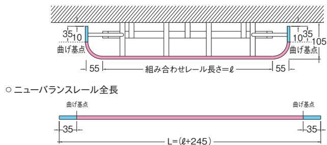
ニューバランスレールと壁のすき間が気になる場合はブラケットの出幅寸法を調整してください。
