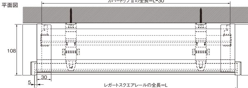
カバートップⅡをジョイントで使用する場合のカット寸法=(L+2)-20mm
