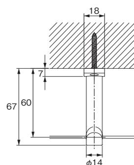
●ワイヤーにテンションをかけて引っ張るため、必ず下地を確認してから取付けてください。コンクリート躯体以外の下地の場合には補強(板厚25mm以上)が必要です。
