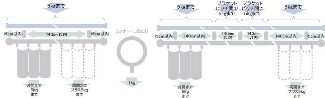
取付寸法図(単位:mm)
