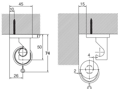
※天井付シングルブラケットは、ブラケット端部を、壁から15mm以上離して取付けてください。(上図はキャップBの場合)
