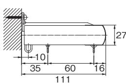
※キャップストップM(ダブル)を使用する場合、ネクステイレールはレガートプリモレールより30mm短くカットしてください。
