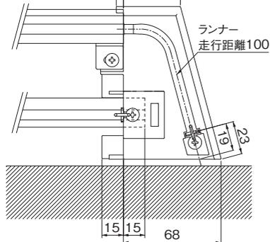
※メタルキャップストップRを使用する場合、ネクステイレールはレガートプリモレールより30mm長くカットしてください。
