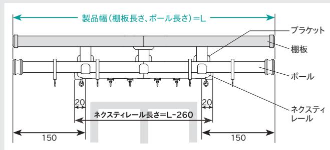
標準タイプB ダブルセットの場合、ネクステレールの長さは[製品幅-100mm]です。
