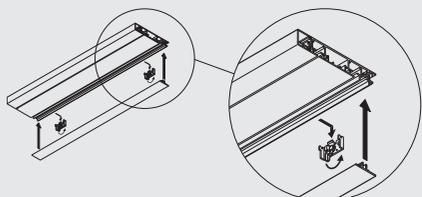
ブラケットにレールを取り付けた後で、リアカバーを取り付けるので、ブラケットが見えません。
