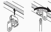
カーテンレールの溝に入れ、90度まわってネジで固定します。
