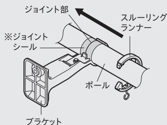
ブラケットスルー機構をご使用の際は専用のリングランナーをお使いください。カーテンのたまり側にはエンドリングランナーをお使いください。リングランナーの脱落を防止します。
