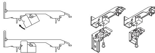
1. カーテンレールのレース側にマルチブロックを取付けます。
