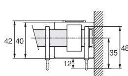
※片壁面の入隅部分に正面付した場合の取付寸法図です。壁面にブラケットを寄せて取付け、キャップDとリングランナーをセットしてください。カーテンの光漏れを抑えてスッキリと納めることができます。
