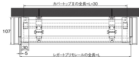
カバートップIIをジョイントで使用する場合のカット寸法=(L÷2)-20mm
