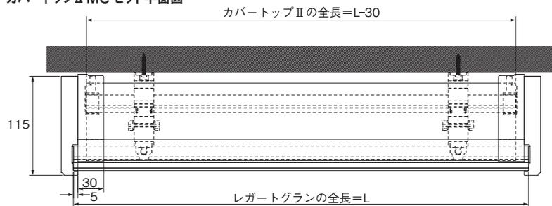
カバートップIIをジョイントして使用する場合のカット寸法=(L÷2)-20mm
