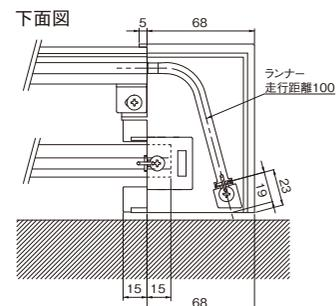
※メタルキャップストップRを使用する場合、レガートスクエアレールはネクステレールより30mm短くカットしてください。
