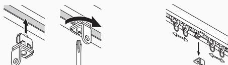
カーテンレールの溝に入れ、90度まわってネジで固定します。
