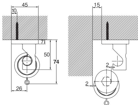
※天井付シングルブラケットは、ブラケット端部を、壁から15mm以上離して取付けてください。(上図はキャップBの場合)
