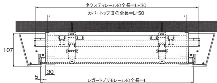
カバートップIIをジョイントで使用する場合のカット寸法=(L÷2)-30mm
