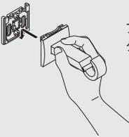
ブラケットベースを取付けた後はすべてワンタッチで簡単・確実に取付けできます。
