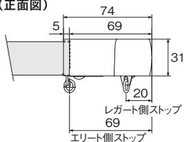
●メタルキャップストップ M/R 納まり図 ※リターン金具 N を取付けた場合の寸法です。
