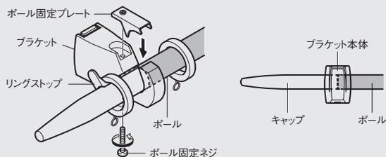
ポールとキャップの継ぎ目をブラケットで隠すことによりポールとキャップに一体感を持たせました。(特許出願中)
