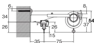
スルーブラケット付 (ブラケット幅=23mm)    スルー CNダブルブラケット付 (ブラケット幅=23mm)
