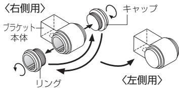
ブラケット本体とキャップ、リングは、取り外しが可能。出荷時には全て「右側用」に組み立てられていますので、右側についたキャップ、左側についたリングをそれぞれ回して取り外し、左右を入れ替えて「左側用」に組み立ててお使いください。
