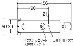
※バランス取付金具は奥行き方向へ伸縮しません。別注タイプの場合L1、L3のご指定寸法に関わらず、壁面からバランス前面までの寸法は165mmです。
