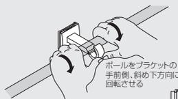
ポールをブラケットの手前側、斜め下方向に回転させる
