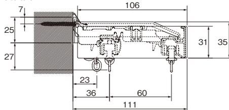
マルチブロックを使用する場合の取付寸法図は P.523のレガートプリモを参考にして頂くか、左記QRコードを読み取ってください。
