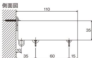
※キャップストップMを使用する場合、ネクステレールはレガートスクエアレールより30mm短くカットしてください。
