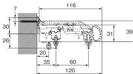
カバートップIIをジョイントして使用する場合のカット寸法=(L÷2)-30mm
