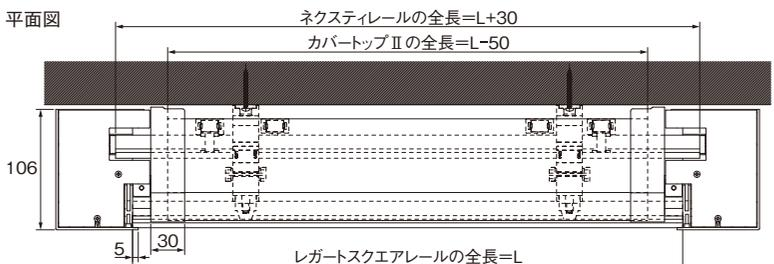
カバートップⅡをジョイントで使用する場合のカット寸法=(L+2)-30mm
