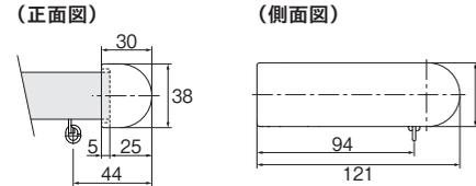
※キャップストップM(ダブル)を使用する場合、エリートレールはレガートレールより30mm短くカットしてください。
