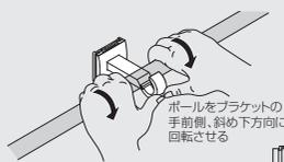
ポールをブラケットの手前側、斜め下方向に回転させる
