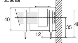
※片壁面の入隅部分に正面付した場合の取付寸法図です。壁面にブラケットを寄せて取付け、キャップDとリングランナーをセットしてください。カーテンの光漏れを抑えてスッキリと納めることができます。
