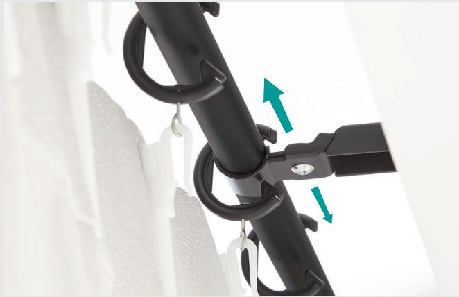
ブラケットスルー機構を採用。ブラケットの取付け位置にかかわらず、カーテンを操作することができるので、大開口の窓にも対応できます。2.11m以上はジョイントを使用して、ご希望の長さでご使用ください。
