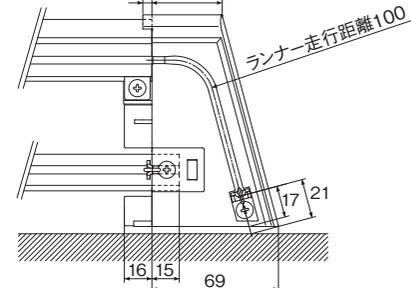
※メタルキャップストップRを使用する場合、レガートレールはエリートレールより30mm短くカットしてください。
