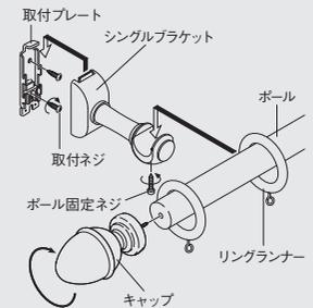
※リングランナー、キャップをセットしたポールをブラケットに乗せ、ポール上部を手で軽く押さえながら、ポール固定ネジで固定してください。
