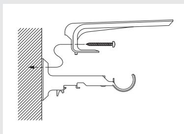
②棚板取付金具の上に棚板を載せ、付属のタッピンネジを棚板下面の溝に打ち込むようにして、棚板と棚板取付金具を固定します。
