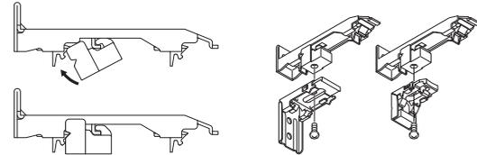
1. カーテンレールのレース側にマルチブロックを取付けます。
