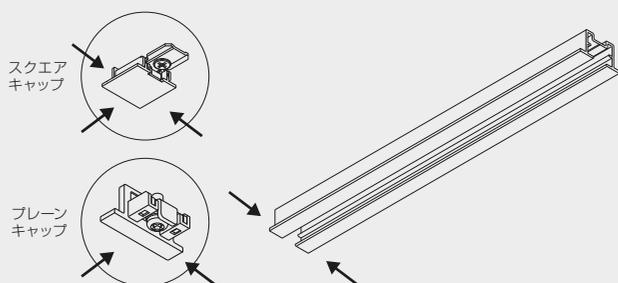
レールの両側やキャップの三方にフランジ(ツバ)のついたデザインで、天井仕上げ材との見切りに美しく納まります。レール高さは9.5mmと12.5mmをラインナップ。9.5mmの仕上げ材でもフラットに納まります。
