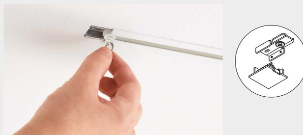
スクエアキャップは取付け後に底面のカバーを外してランナーの抜き差しができます。レールを天井に埋め込んでもカーテンの掛け替えでランナー数が変わっても安心です。(カバーの取外しにはマイナスドライバーが必要です。)
