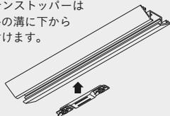
生地や芯地の反発で閉まってしまうカーテンもレール内にカーテンストッパーを設置し、いつもの操作で好きな位置に止められます。
