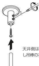
天井側は、ベースを天井に固定し吊棒のネジを締めてください。
