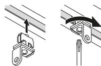
カーテンレールの溝に入れ、90度まわしてネジで固定します。
