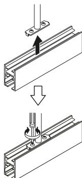
レール側は、レール上部の溝に金具を入れ中のナットを回転させてネジ止めしてください。
