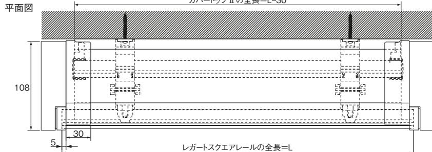
カバートップIIをジョイントで使用する場合のカット寸法=(L÷2)-20mm
