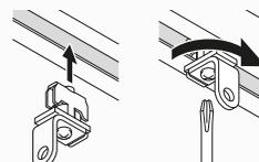
カーテンレールの溝に入れ、90度まわしてネジで固定します。
