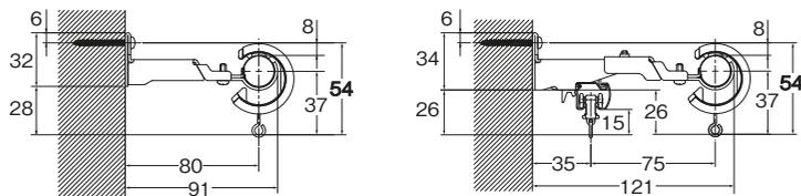
〈入隅・出隅へ取付ける際の寸法図〉 (プレーンキャップ使用時)
