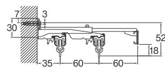
ニューバランスレールのブラケットは組み合わせるレールの上に乗せるようにして壁面にビスで取付けてください。
