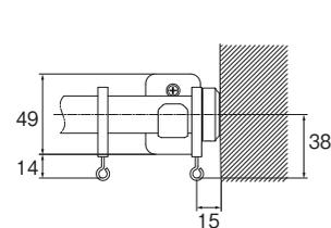
〈入隅・出隅へ取付ける際の寸法図〉(キャップB使用時)
