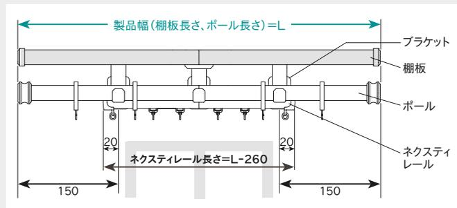
標準タイプB ダブルセットの場合、ネクスティレールの長さは[製品幅-100mm]です。
