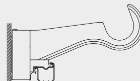
エリートダブルセットの際に使用するEダブルブラケットは、エリート用のブラケットが一体になっています。
