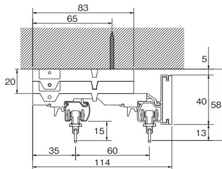
カバートップII MC セット平面図
