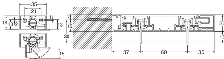
※天井面近くに取り付ける場合、ブラケットと天井面の間に35mm以上の隙間をあけてブラケットを取り付けてください。シングルレール付けの場合は25mm以上の隙間が必要です。
