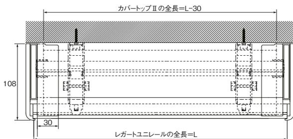
カバートップIIをジョイントで使用する場合のカット寸法=(L+2)-20mm
