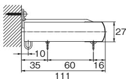
※キャップストップM（ダブル）を使用する場合、ネクステレールはレガートプリモレールより30mm短くカットしてください。
