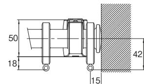
※片壁面の入隅部分に正面付した場合の取付寸法図です。壁面にブラケットを寄せて取付け、キャップDとリングランナーをセットしてください。カーテンの光漏れを抑えてスッキリと納めることができます。
