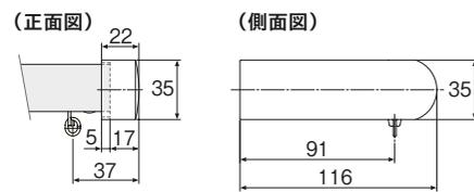
※メタルキャップストップM(ダブル)を使用する場合、エリートレールはレガートレールより30mm短くカットしてください。
