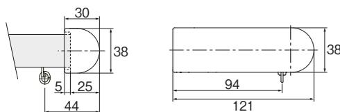
※キャップストップM(ダブル)を使用する場合、エリートレールはレガートレールより30mm短くカットしてください。
