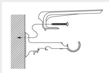
②棚板取付金具の上に棚板を載せ、付属のタッピンネジを棚板下面の溝に打ち込むようにして、棚板と棚板取付金具を固定します。(特許登録済)
