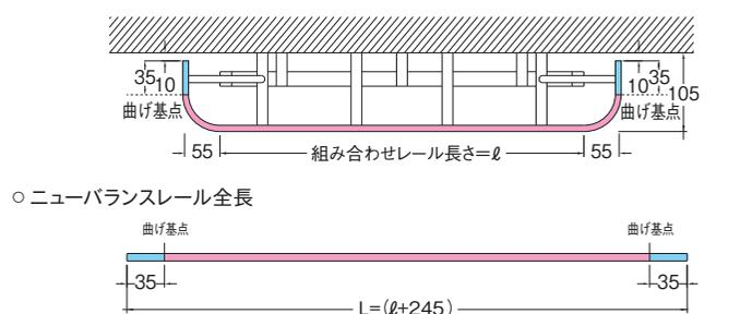
ニューバランスレールと壁のすき間が気になる場合は、ブラケットの出幅寸法を調整してください。
