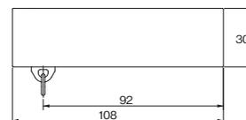
●キャップストップM納まり図 ※キャップ一体型リターン金具Nを取付けた場合の寸法です。
