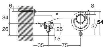
スルーブラケット付 (ブラケット幅=23mm)    スルー CNダブルブラケット付 (ブラケット幅=23mm)
