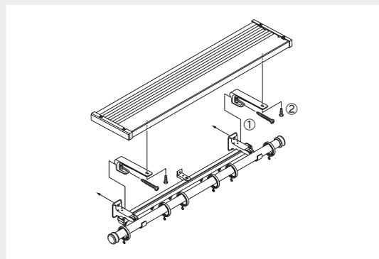
①棚板取付金具に付属された取付ネジを使って、ヴィンクスブラケットと棚板取付金具を共締めします。(φ3.5×50)
