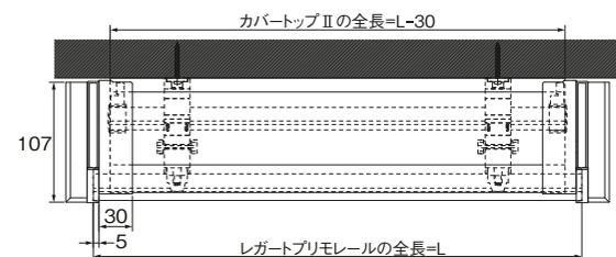
カバートップⅡをジョイントで使用する場合のカット寸法=(L÷2)-20mm
