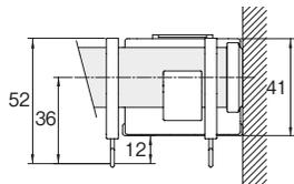
※片壁面の入隅部分に正面付した場合の取付け寸法図です。
