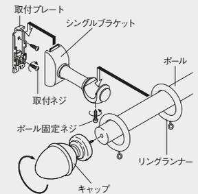
※リングランナー、キャップをセットしたボールをブラケットに乗せ、ボール上部を手で軽く押さえながら、ボール固定ネジで固定してください。
