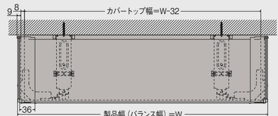
※( )の寸法は窓枠上の横下地に取付ける際の取付ネジの寸法です。
