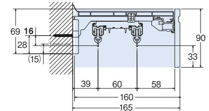
※ ( ) の寸法は窓枠上の横下地に取付ける際の取付ネジの寸法です。
