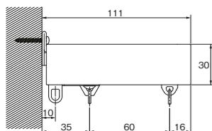
※キャップストップMを使用する場合、ネクステレールはレガートユニレールより30mm短くカットしてください。
