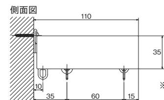
※キャップストップMを使用する場合、ネクステレールはレガートスクエアレールより30mm短くカットしてください。
