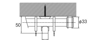
取付寸法図 (単位: mm)
