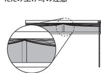
※中央のスクリーンジョイント部は重なるの厚みにより畳み上げると図のように山なりになります。
