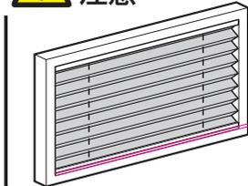
コードレスタイプのメカを窓枠内付けで設置した場合、全閉時にボトムが少し浮きます。
