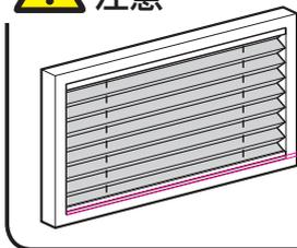
コードレスタイプのメカを窓枠内付けで設置した場合、全閉時にボトムが少し浮きます。
