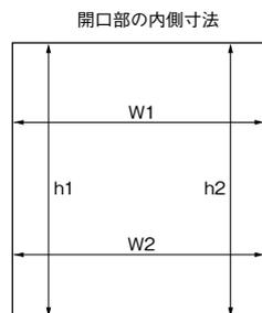
開口部の内側寸法 (w1, w2, h1, h2) を1mm単位で採寸してください。そのうち寸法の【小さい方の幅と高さの寸法から1mm差し引いて】ご指定ください。
