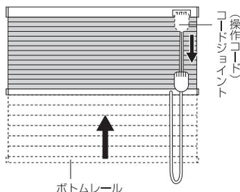
ボトムレールが途中にある場合は、コードジョイント又は操作コードを少し下に引き、手を一旦緩めてから再びコードジョイント又は操作コードを引き、スクリーンを止めたい位置で手を離してください。
