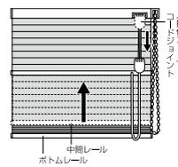
中間レールが途中にある場合は、コードジョイント又は操作コードを少し下に引き、手を一旦緩めてから再びコードジョイント又は操作コードを下方方向に引き、中間レールを止めたい位置で手を離してください。
