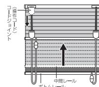
中間レールが途中にある場合は、中間レールにつながる操作コードを少し下に引き、手を一旦緩めてから再び操作コードを引き、中間レールを止めたい位置で手を離してください。
