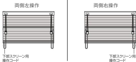
※両側左操作・両側右操作の区別は、下部スクリーン用の操作コードの位置を基準とします。
