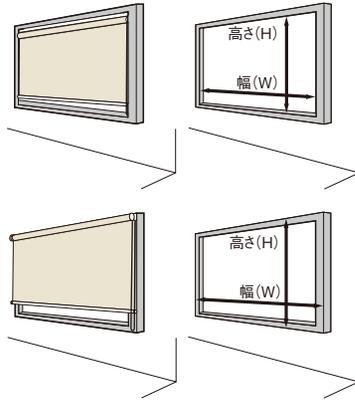
●窓枠の外側に取付ける場合（正面付け）
