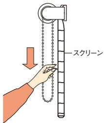
ボトムレールが製品高さの位置に来るまでスクリーンを下ろした状態で更に奥のボールチェーンを引くとスクリーンが開き調光状態になります。
