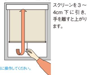
\*スクリーンの上げ下げは必ず中央のプルボールで垂直に操作してください。
