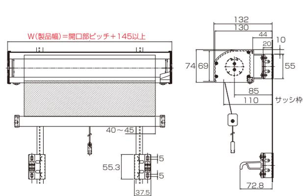
※クラッチタイプ(ガイドワイヤー仕様)の場合、ガイドワイヤーを垂直に設置しないと、スクリーンの昇降に不具合を生じますので製品幅は、サッシ開口寸法(サッシ枠固定金具取付位置)+75mmのサイズでご指定ください。
