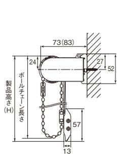
※天井付けの場合、製品高さ (H) はブラケット上端からボトムレール下部までの寸法です。
