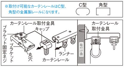
※取付け可能なカーテンレールはC型、角型の金属製レールになります。
