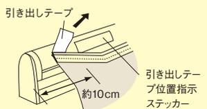
2) スクリーン上端の白い樹脂部分とローラーパイプの間に指をはさみ、そのままスライドさせてスクリーンを外します。
