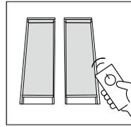
手軽な電動タイプ。手の届かない高窓や吹き抜けなどで操作しにくい窓もリモコンスイッチで昇降操作が行えます。
