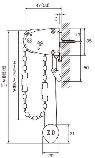
※正面付けの場合、製品高さ(H)はローラーパイプ上端からウエイトバーキャップ下部までの寸法です。
