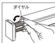
2) スプリングの入っているテンションブラケットを押し付けながら、反対側のプレートキャップから突き当てプレートを外してください。
