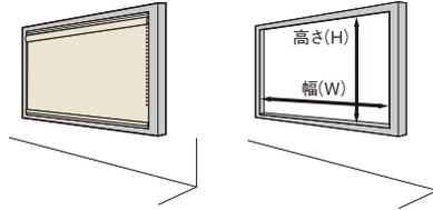
●窓枠の外側に取付ける場合(正面付け)
