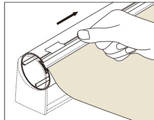
④ウエイトバーをスクリーンに差し込み、プルセットを取りつけてください。プルセットはウエイトバーに密着させ、固定レバーを倒してロックしてください。(標準プルコードタイプ、浴室プルコードタイプのみ)
