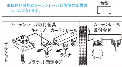
※取付け可能なカーテンレールは角型の金属製レールになります。
