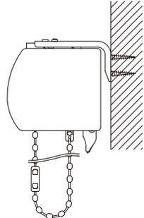
※スクリーンを巻き上げた状態では、ボトムレールは製品後方に収納されます。
