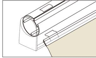
②スクリーンを図のように巻き込んだ状態でスクリーン上部の白い樹脂部分をローラーパイプの溝に差し込みます。
