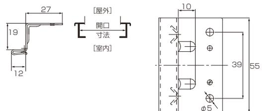
※クラッチタイプ(ガイドワイヤー仕様)の場合、ガイドワイヤーを垂直に設置しないと、スクリーンの昇降に不具合を生じますので製品幅は、サッシ開口寸法(サッシ枠固定金具取付位置)+75mmのサイズでご指定ください。
