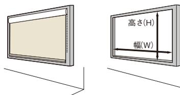
●窓枠の外側に取付ける場合(正面付け)
