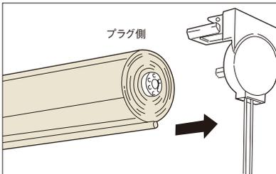
④反対側のセンターピンをブラケットに押し上げてはめ込んでください。外れ止めのラッチがありますので、確実に差し込んでください。
