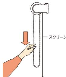
調光状態のスクリーンを閉じるには、手前のボールチェーンを引いてください。スクリーンが閉じます。更に引き続けるとスクリーンが上がります。
