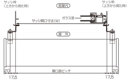
※クラッチタイプ(ガイドワイヤー仕様)の場合、ガイドワイヤーを垂直に設置しないと、スクリーンの昇降に不具合が生じますので製品幅は、サッシ開口寸法(サッシ枠固定金具取付位置) + 75mmのサイズでご指定ください。
