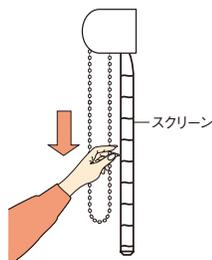
ボトムレールが製品高さの位置に来るまでスクリーンを下ろした状態でご奥のボールチェーンを引くとスクリーンが開き調光状態になります。
