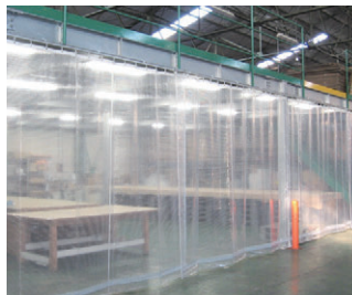
作業場仕切り
