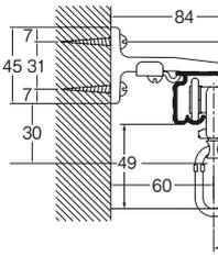
クリップ付ブラケットプレート使用 ※ ( )はクリップ付ブラケットプレートMの場合
