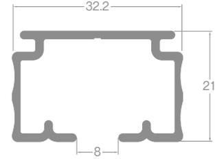
レール断面図 (単位: mm)
