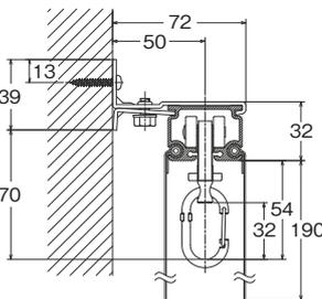
クリップ付ブラケットプレート使用 TO-40 ステンレス、アルミ共通
