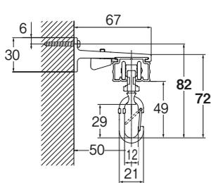
クリップ付ブラケットプレート使用 ※ ( )はクリップ付ブラケットプレートMの場合
