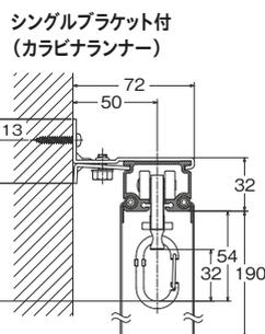
クリップ付ブラケットプレート使用 TO-40 ステンレス、アルミ共通
