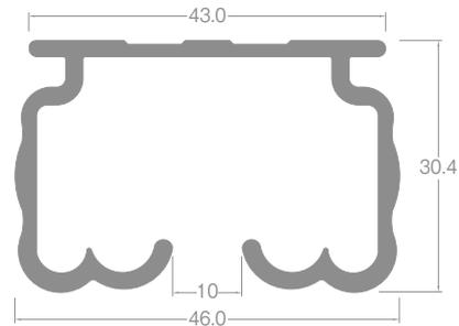
レール断面図 (単位: mm)
