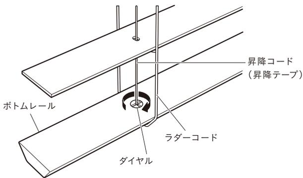
※ダイヤル 1/4 回転で約 7.5mm 短くなります。最大で 1 回転＝約 30mm の調整が可能です。
