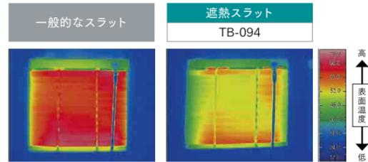
ブラインド全体が熱を吸収し、発熱しています。赤外線を反射して、発熱を抑えています。
